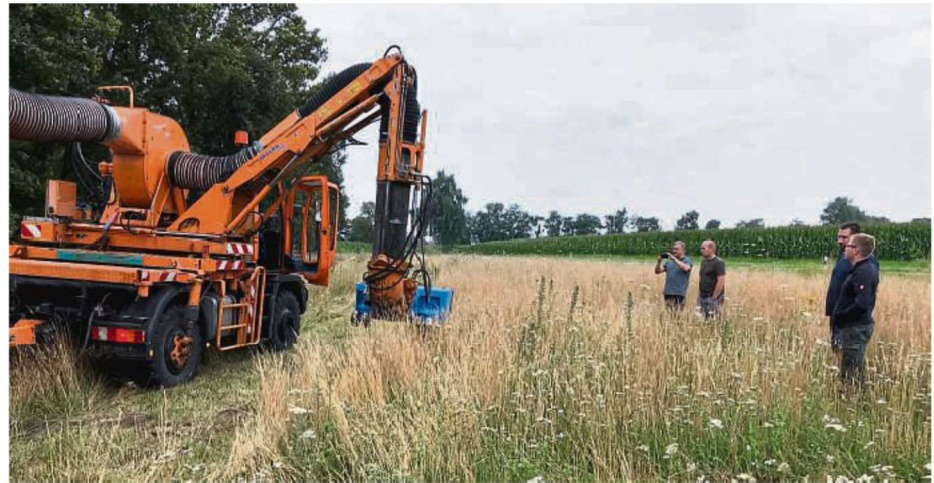
DVL und LPV stellten im Rahmen einer von ihnen initiierten Praxisvorführung jetzt in Ströhen einen insektenschonenden Mähkopf vor. FOTO: EHLERS
